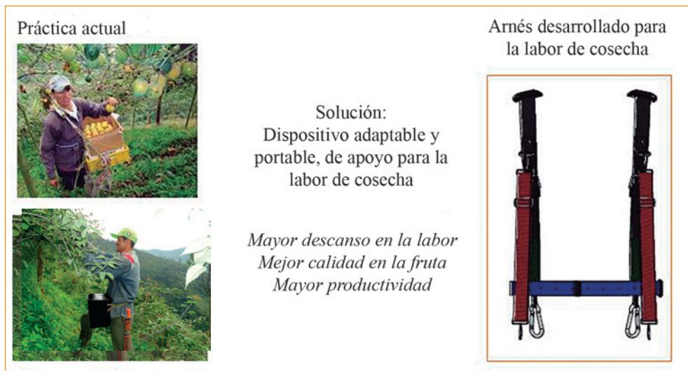
Figura C.12. Prototipo ergonómico y portable, diseñado para mejorar y aliviar la carga en la labor de cosecha de frutos pequeños
