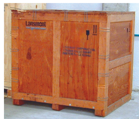
Equipo pesado embalado en guacal de madera.
