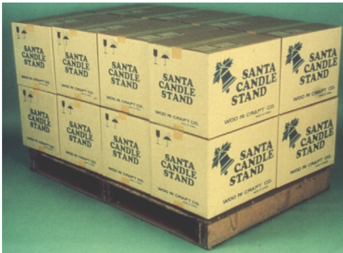
Unidad de carga formada por cajas arrumadas sobre una estiba de madera.
