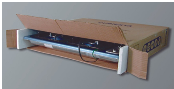
Electrodoméstico embalado en caja de cartón corrugado. Uso del poliestireno expandido como material de amortiguamiento.
